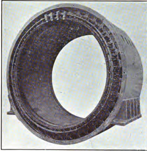
FIG. 61.—Main Motor Stator for U. S. S. New Mexico
